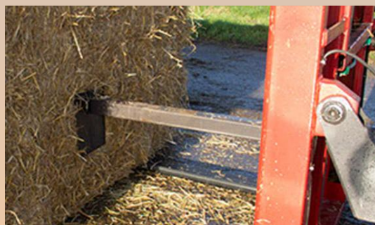
En specialdesignet pushoff gør det let at trække gaflerne ud under stakken.
