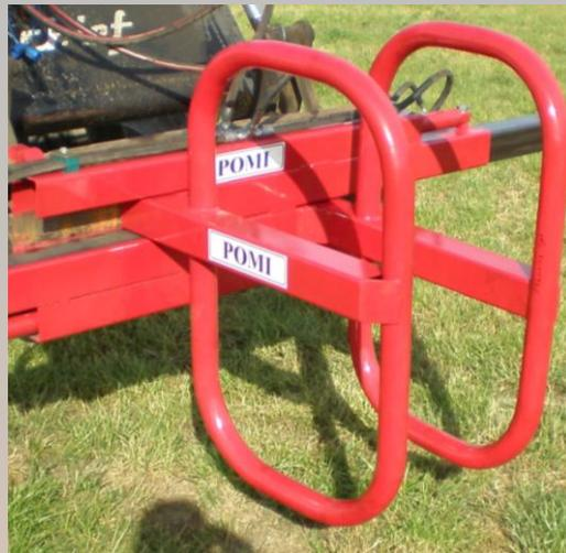
Die Ballenzange wird über einen Schalter im Traktor gesteuert, der das stufenlose Einstellen der Zange von 400 bis 2.000 mm zulässt.
