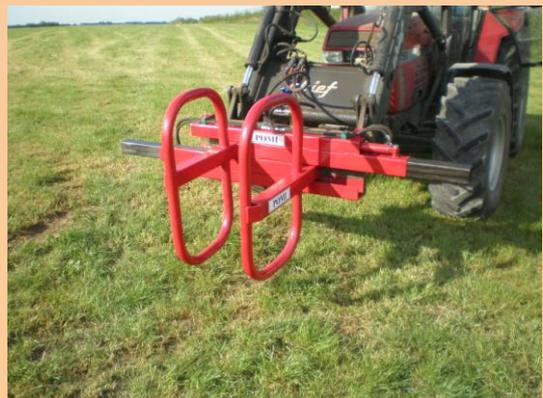
Die Ballenzange für 9 Ballen ist die optimale Lösung für die effektive Handhabung handlicher Mini-Ballen von 15 - 50 kg.
